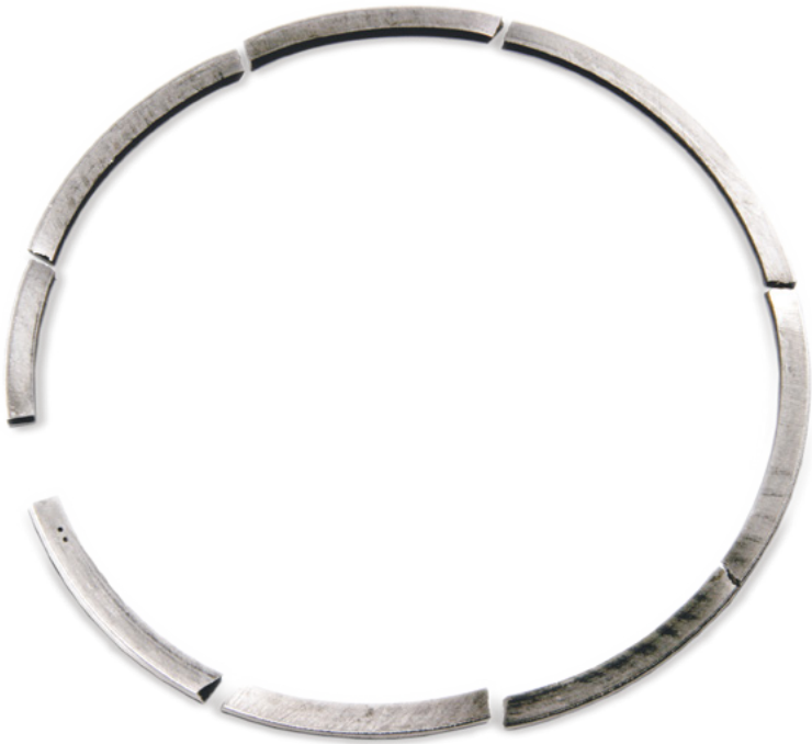
Fascia elastica rotta
