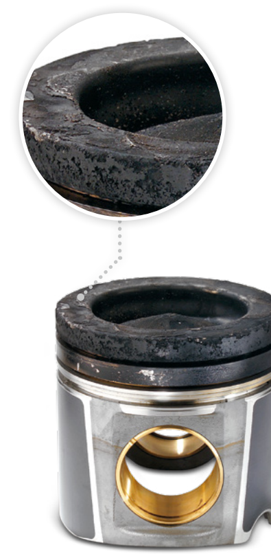
Fig. 3: Strato di calamina sul bordo della superficie
