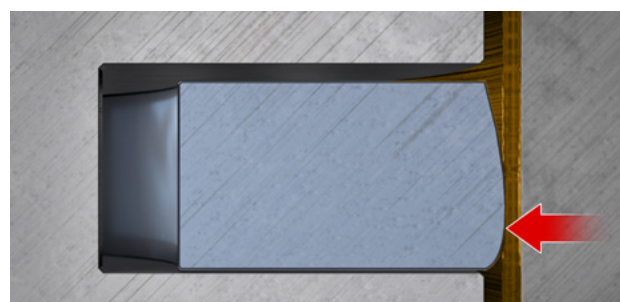
Fig. 3: Superfici di scorrimento della fascia elastica bombate e asimmetriche
