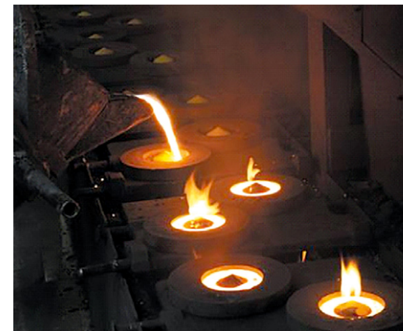
Processo di fusione di una fascia elastica
