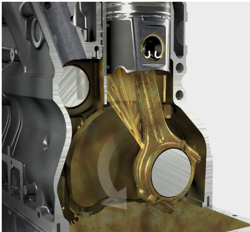
Fig. 1: I fori dell'olio nella biella permettono la lubrificazione della superficie di scorrimento
