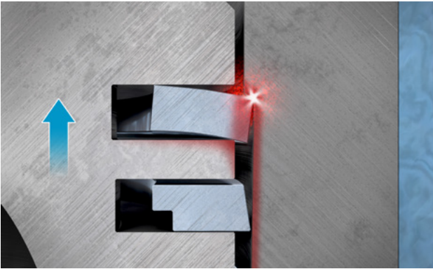
Fig. 3: Battito della fascia elastica in un pistone nuovo
