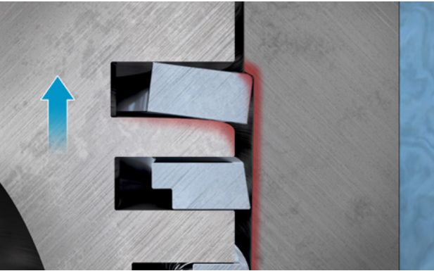
Fig. 2: Battito della fascia elastica in un pistone vecchio
