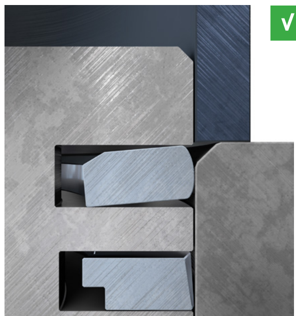
Fig. 2: Smusso piccolo sull'alesaggio del cilindro – la fascia elastica scorre sulla fessura
