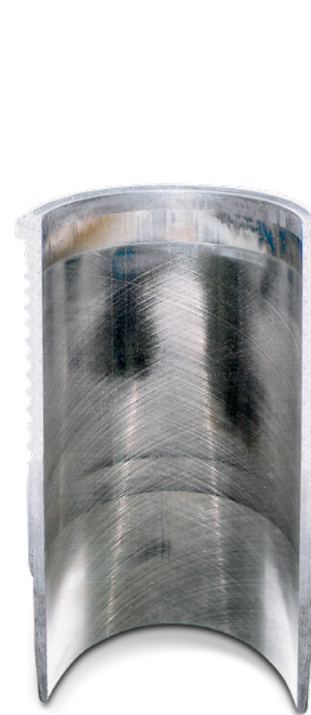
Fig. 2: Punti lucidi e bruniti nella parte superiore del cilindro
