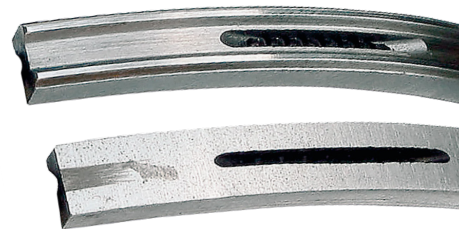
Fig. 3: Anello raschiaolio nuovo e usurato
