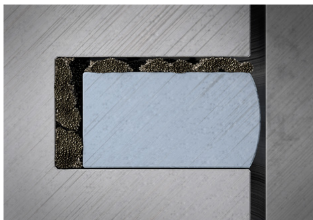
Fig. 1: Incrostazioni di sporco nella scanalatura anulare
