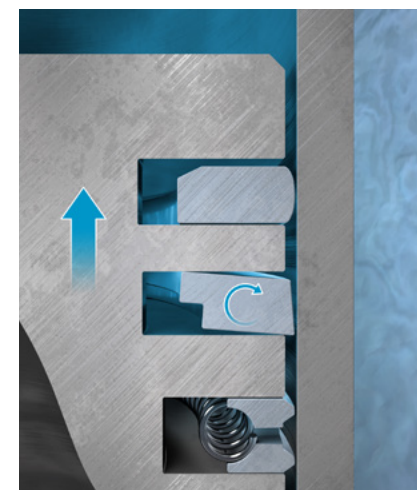
Fig. 5: Senza pressione di combustione
