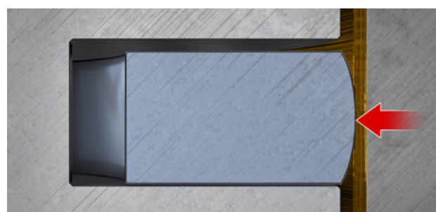
Fig. 2: Superfici di scorrimento della fascia elastica bombate e simmetriche
