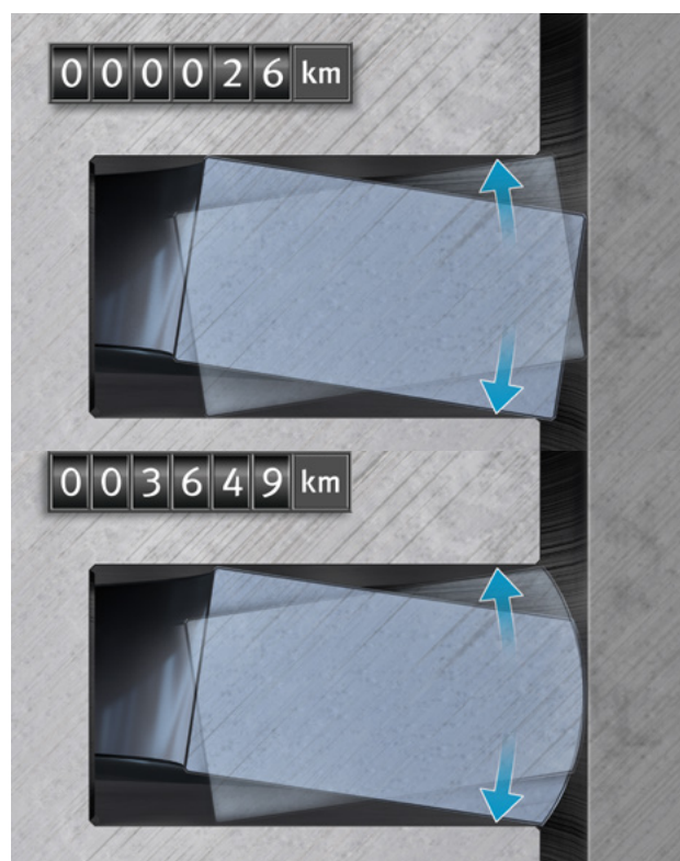
Fig. 1: Bombatura causata dall'usura in fase di rodaggio
