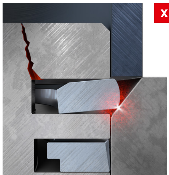
Fig. 1: Smusso troppo grande sull'alesaggio del cilindro – durante il montaggio la fascia elastica rimbalza tra il nastro per fasce elastiche e il cilindro e il pistone è bloccato
